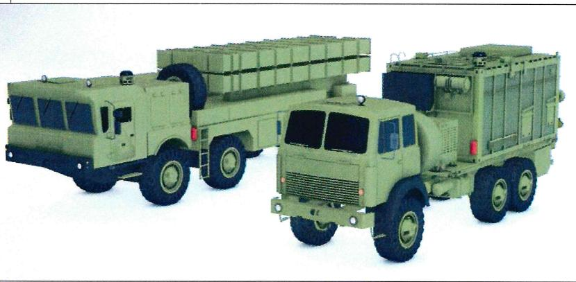
■ Komponenty raketového systému V-300 Polonez s nainštalovanou súpravou KRP Miraž: veliteľské vozidlo V-300 MBU (vľavo) a samohybne odpalovacie zariadenie V-300 BM
