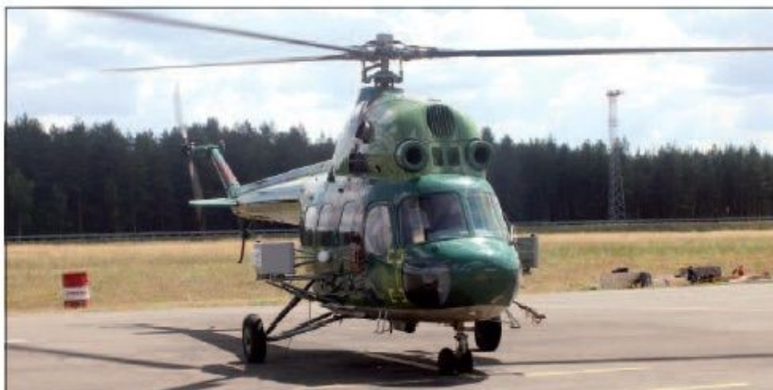
■ Pri tomto pohľade na skúšobný vrtuľník sú viditeľné oba kontajnery systému Amulet
